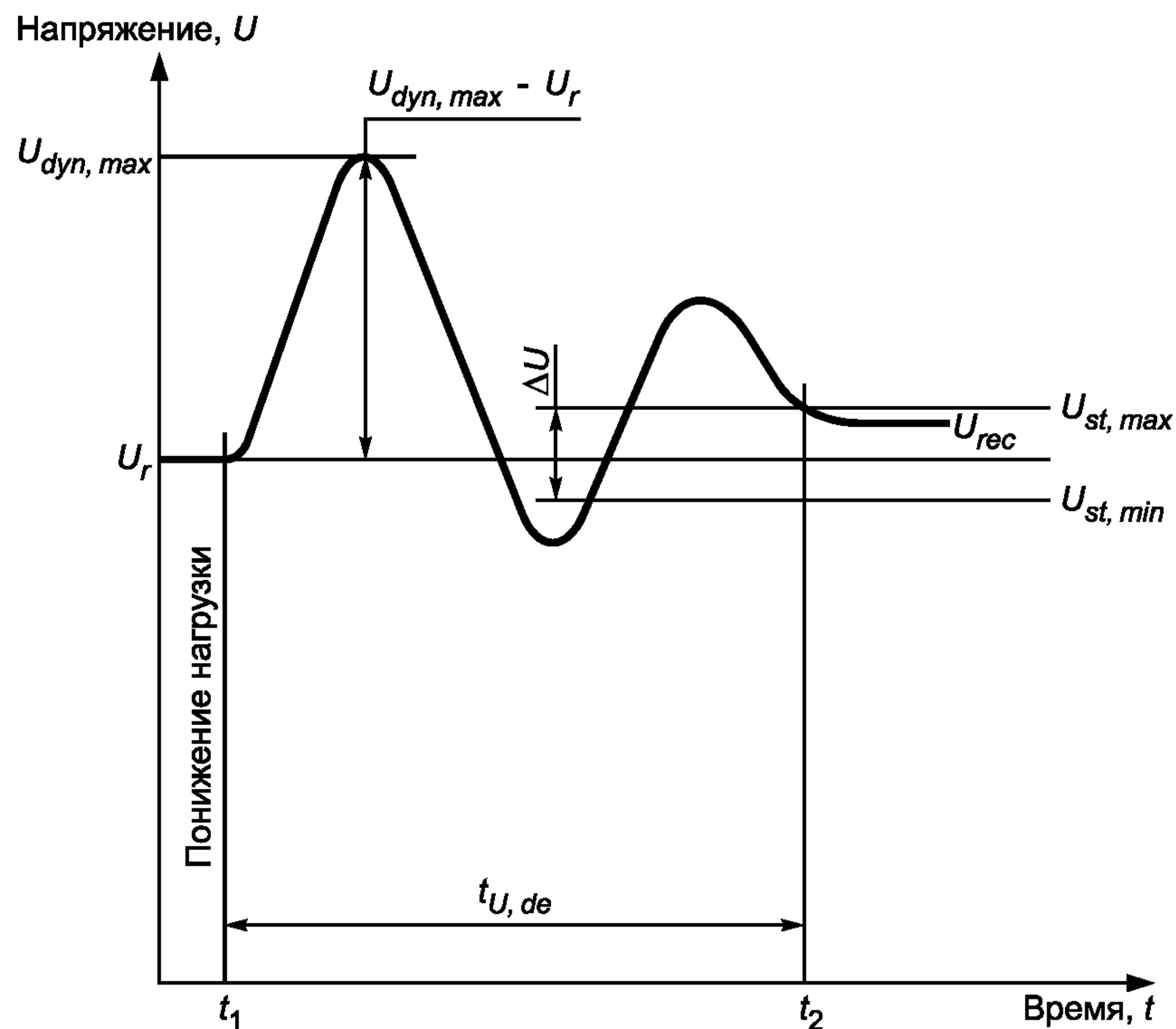
Рисунок А.2 — Характеристика переходного напряжения (понижение нагрузки)
